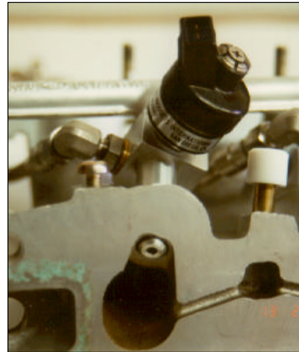
Bild : H 2 -Einblas-Einheit im Saugrohr
