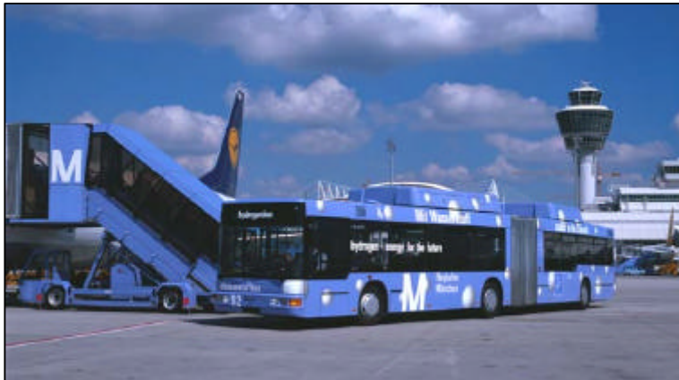
Bild : MAN-Bus mit Wasserstoff-Ottomotor (Quelle : MAN AG)
