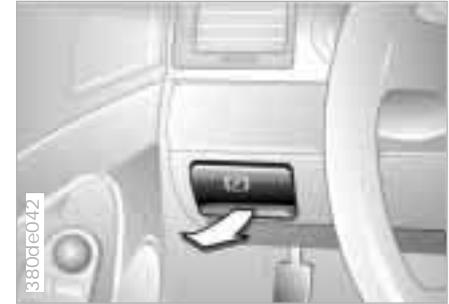
Zum Lösen der Bremse den Griff ziehen. Bitte beachten Sie, daß die Bremse dann unmittelbar löst.
