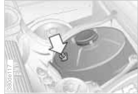
5 Die Minuspole der Batterien verbinden. Dazu erst am Minuspol der stromgebenden Batterie bzw. an einer Motor- oder Karosseriemasse des stromgebenden Fahrzeugs anschließen und dann an der Motor- oder Karosseriemasse des zu startenden Fahrzeugs anklammern. Beim BMW ist es eine spezielle Mutter am Federbeindom, siehe Pfeil im Bild
