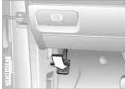
Das Pedal treten, die Kontrolleuchte „P“ in der Instrumentenkombination leuchtet in Zündschlüsselstellung 2.
