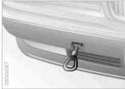
Die schraubbare Schleppöse befindet sich im Bordwerkzeug und muß immer mitgeführt werden. Sie kann vorn oder hinten am Fahrzeug eingeschraubt werden und ist ausschließlich zum Schleppen auf der Fahrbahn vorgesehen.
