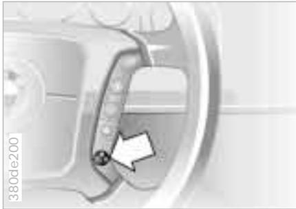
Die Lenkradheizung funktioniert in Zündschlüsselstellung 2. Zum Ein- und Ausschalten die Taste (Pfeil) drücken.
