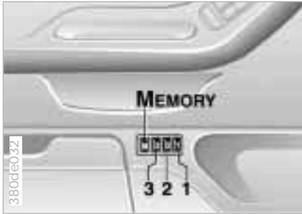
Sie können drei verschiedene Fahrer-sitz-, Außenspiegel- und Lenkradpositionen (nur in Verbindung mit elektrischer Lenkradeinstellung) speichern und abrufen. Das Bild zeigt die Tasten dazu an der Fahrertür.
