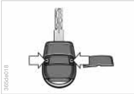
2 Zwei Schrauben (Pfeile) lösen und Deckel abnehmen.
