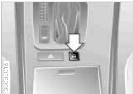
Mit dieser Taste betätigen Sie bei geschlossenen Vordertüren die Zentralverriegelung. Damit werden Türen, Heckklappe und Tankklappe nur entriegelt bzw. verriegelt, nicht aber diebstahlgesichert.
