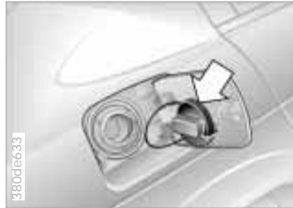
Tankverschluß in die Halterung an der Tankklappe stecken.
