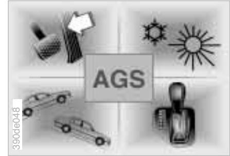
Die Adaptive Getriebesteuerung AGS errechnet für Fahrzeuge mit Automatic-Getriebe aus einer Vielzahl von Faktoren die jeweils bestmögliche Gangwahl. Sie berücksichtigt dabei Ihre individuelle Fahrweise, die Fahrsituation, den Straßenzustand und die Verkehrsverhältnisse.
