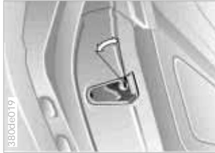
An einer Fondtür Schlüssel in den Schlitz stecken und nach außen drehen:
