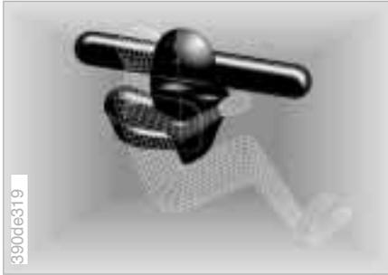
Verzögerungssensoren überprüfen laufend die auf das Fahrzeug wirkenden Beschleunigungen. Wird aufgrund eines Frontalaufpralls eine Verzögerung erreicht, bei der die Schutzwirkung der Sicherheitsgurte alleine nicht mehr ausreichen würde, werden die Gasgeneratoren von Fahrer- und Beifahrer-Airbag parallel gezündet. Der Beifahrer-Airbag wird jedoch nur dann ausgelöst, wenn ein weiterer Sensor erkannt hat, daß der Beifahrersitz besetzt ist.
