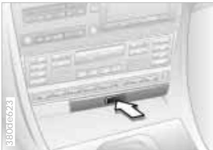
Je zwei Halter für Getränkedosen befinden sich in einem Fach vorn in der Mittelkonsole sowie hinten in der Front der Rücksitzbank im Bereich des mittleren Sitzplatzes.
