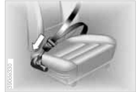
Der Gurtschloßstrammer sorgt dafür, daß bei einer Kollision der Gurt deutlich fester anliegt und den Körper sicher im Sitz hält. In Sekundenbruchteilen wird das Gurtschloß mit Hilfe von Gasdruck zurückgezogen, Schulter und Beckengurt werden dadurch gleichzeitig gestrafft. So wird einem Durchrutschen unter den Beckengurt weiter entgegengewirkt.
