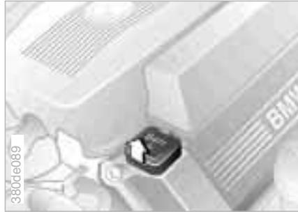
4 Mit einem Starthilfekabel den Pluspol der anderen Batterie mit dem Fremdstartstützpunkt im Motorraum des BMW verbinden. Die Abdeckkappe des Fremdstartstützpunktes ist mit „Batt. +“ markiert, siehe Bild. Zum Abnehmen die Kappe hochziehen. Das Bild zeigt exemplarisch den Fremdstartstützpunkt des BMW 735i/L und 740i/L. Für die anderen Modelle: siehe Motorraum, ab Seite [150](#)
