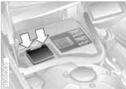
Sollte ein Stromverbraucher ausfallen, schalten Sie ihn aus und kontrollieren Sie die Sicherung.
