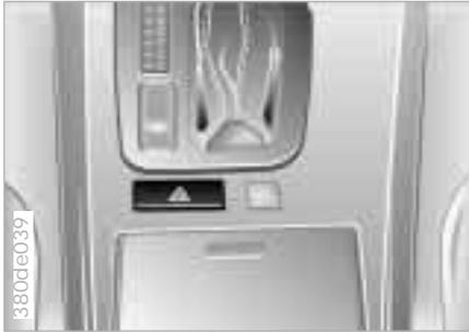
Die Drucktaste leuchtet bei eingeschalteter Warnblinkanlage periodisch auf. Bei eingeschalteter Fahrzeugbeleuchtung ist die Drucktaste beleuchtet.
