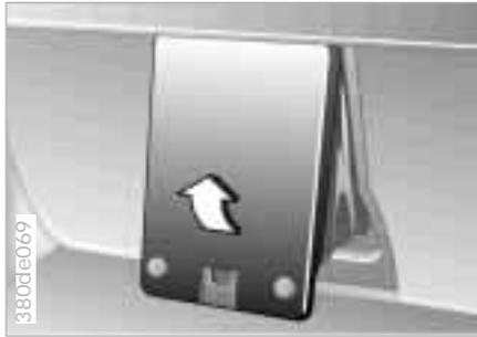
Ladeklappe vom Kofferraum aus mit den Magnethaltern an der Unterseite der Hutablage befestigen.
