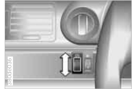
Zur Regelung der Beleuchtungsstärke das Rändelrad drehen.
