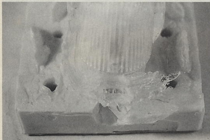
Der Gießgrat muß sorgfältig abgetrennt und überschleifen werden; das Harz kann sehr hart sein und dementsprechend schnell brechen.
