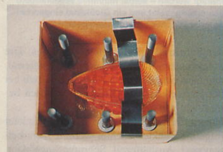
Das Glas muß (für den zweiten Abguß!) waagrecht und tief genug in der Form plaziert werden.
